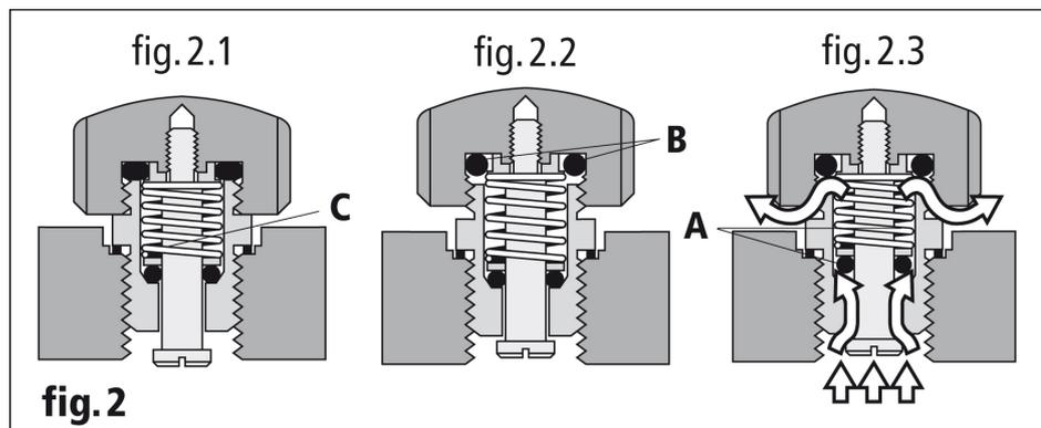
圧力低減過程で、このメカニズムを機能させるには、エスケープバルブのリユウズをゆるめます ( fig. 2.2 )。ここで弁は外側からは防水性となります。内圧が外圧より高くなると、パッキンAが押され、密閉状態が解除され、ガスが逃げます ( fig. 2.3 )。一旦圧力が解放されると、パッキンAはスプリングCにより元の位置に押し戻されます ( fig. 2.2 )。
