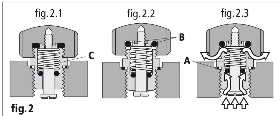
圧力低減過程で、このメカニズムを機能させるには、エスケープバルブのリュウズをゆるめます ( fig. 2.2 )。ここで弁は外側からは防水性となります。内圧が外圧より高くなると、パッキンAが押され、密閉状態が解除され、ガスが逃げます ( fig. 2.3 )。一旦圧力が解放されると、パッキンAはスプリングCにより元の位置に押し戻されます ( fig. 2.2 )。
